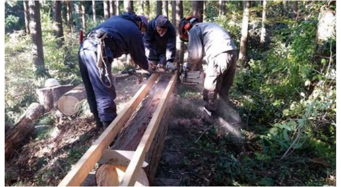
倒木を板材に製材している様子
